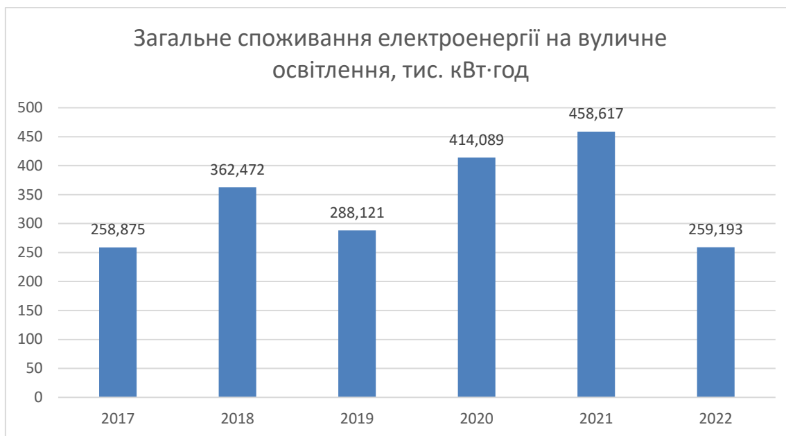
Рисунок 13 Загальне споживання електроенергії на вуличне освітлення, кВт·год
