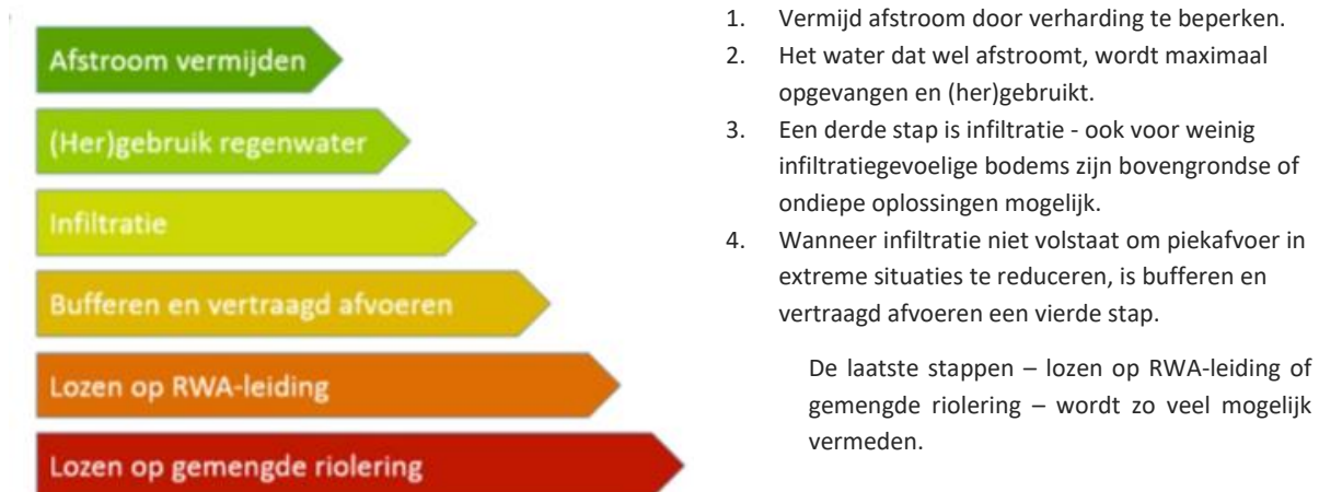
Figuur 17: Ladder van Lansink - toepassen van maatregelen inzake verwerking hemelwater. Bron: Leidraad ontwerpen van bronmaatregelen – Integraal waterbeleid
