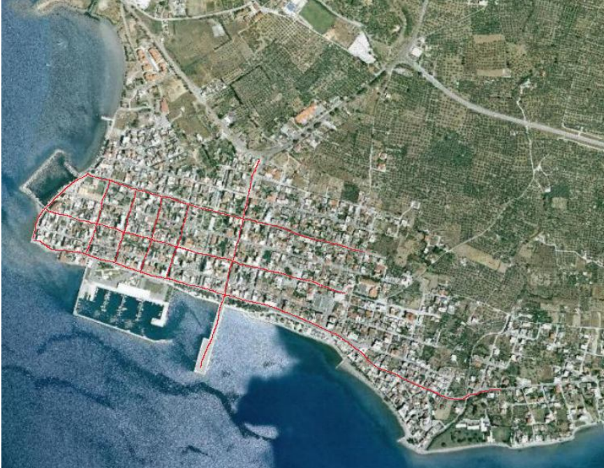
Σχήμα 5.15 : Προτεινόμενη χωροθέτηση ποδηλατοδρόμου στην πόλη της Ιτέας
