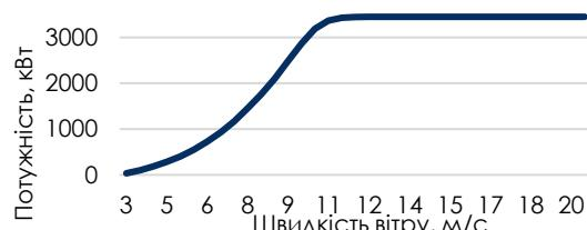
Рис. 1.11. Крива потужності вітротурбіни Vestas V126-3.45.
