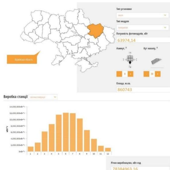
Рис. 1.8. Розрахунок теоретичної потужності СЕС згідно із визначеною площею<sup>2</sup>
