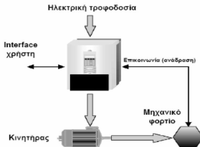
Εικόνα 5.18 Βασικές συνιστώσες συστήματος ηλεκτρικής κίνησης
