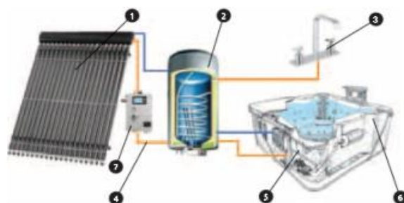
Схема 1. Принципова схема роботи геліоколектора
