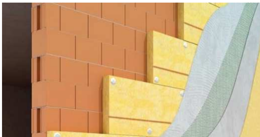
Fig.12.1. Differenti strati di un "cappotto termico"
