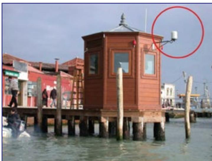
Figura 64 – Rilevatore innalzamento maree
