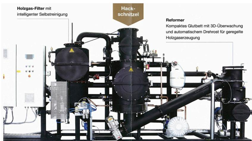
*Holzgas das vor Ort aus Pellets oder Hack-schnitzel gewonnen wird, ist mittlerweile für den Betrieb eines BHKW's auch eine technische und wirtschaftliche Alternative.*
