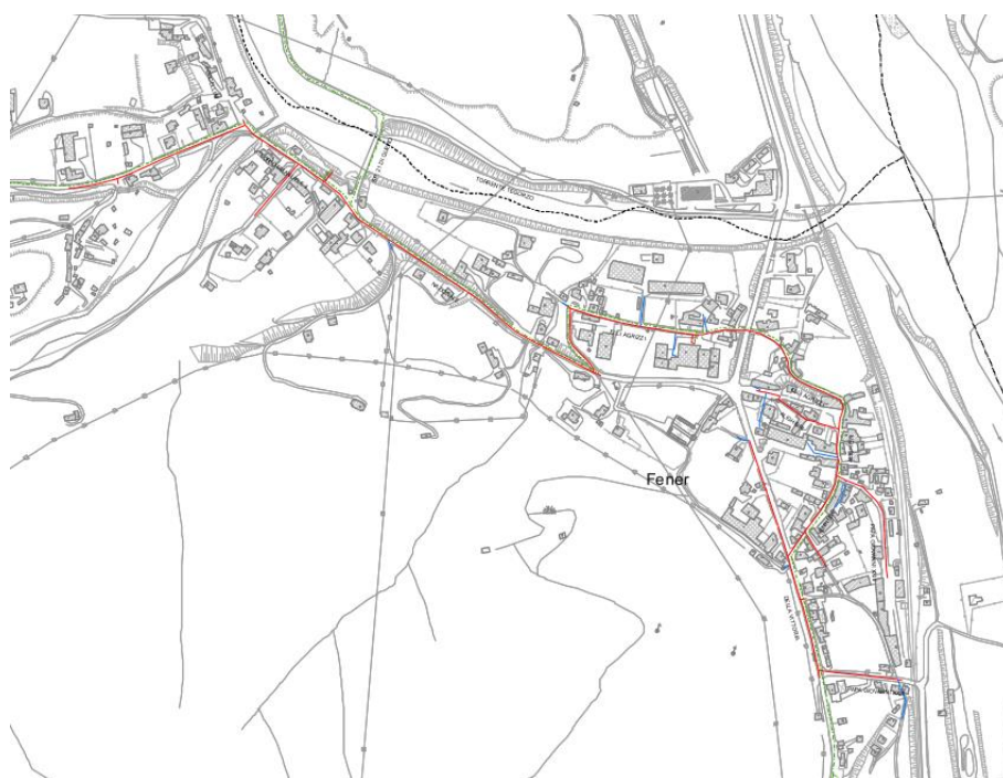
Schema funzionale rete gas metano Alano di Piave - Fener (fonte: Ascopiave spa)
