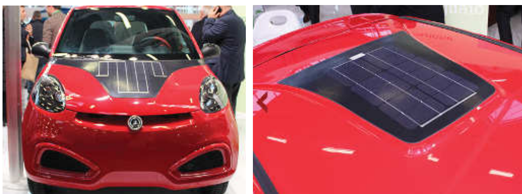
Fig. 6.5 – Foto della vettura elettrica: particolare anteriore e del tetto munito di pannelli fotovoltaici.
