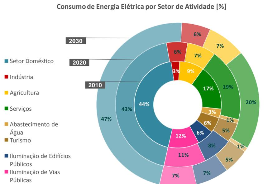
Figura 5 - Consumo de Energia Elétrica por Setor de Atividade em 2010, 2020 e 2030 [%]
