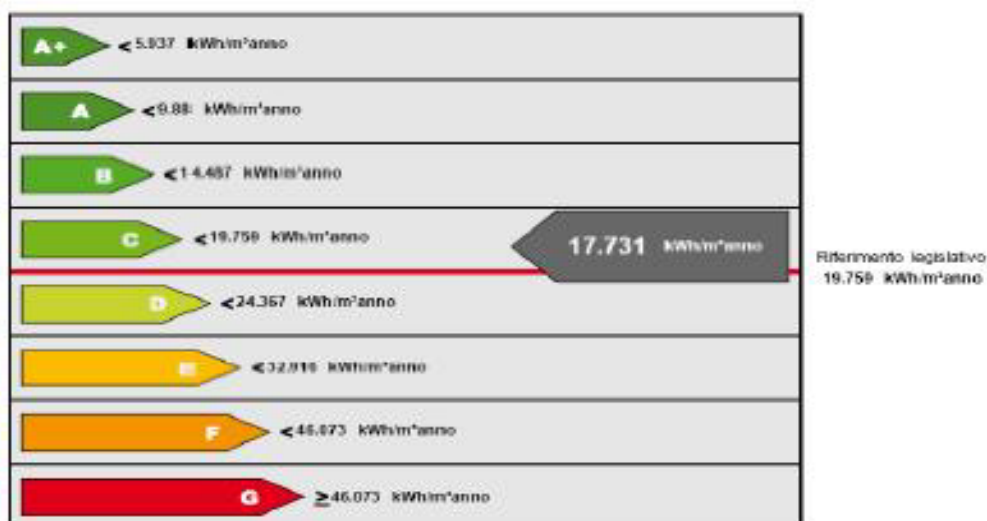
Tab 5.1.4.4 Classe energetica del Municipio dopo dell'intervento
