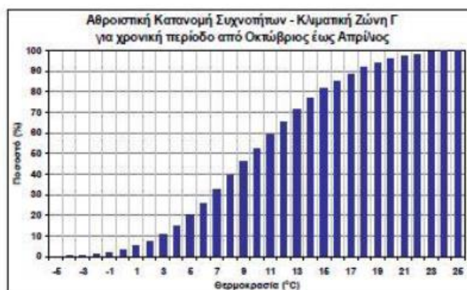
Εικόνα 5: Αθροιστική κατανομή εξωτερικών θερμοκρασιών κατά τη χειμερινή περίοδο για την Κλιματική Ζώνη Γ (Τ.Ο.Τ.Ε.Ε.20701.3-2010)
