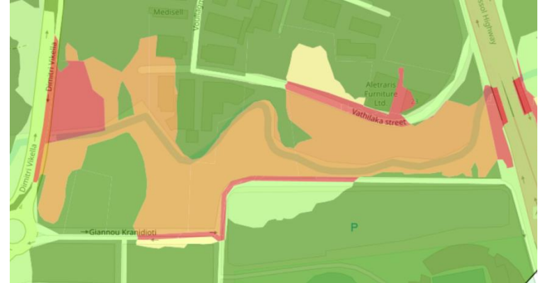
Εικόνα 30. Περιοχές υψηλού κινδύνου για πλημμύρες - Γέφυρες Δημήτρη Βικέλα και Αυτοκινητόδρομος 1 και παραπήλαιοι δρόμοι και οικόπεδα.
