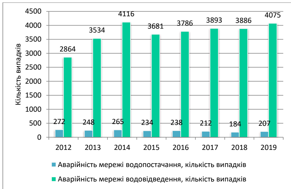
Рис. 3.10. Аварійність мереж водопостачання та водовідведення в м. Коростень
