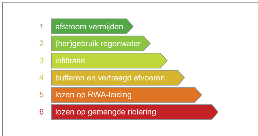
Figuur 2: Ladder van Lansink (CIW, 2012, Leidraad ontwerpen van bronmaatregelen)
