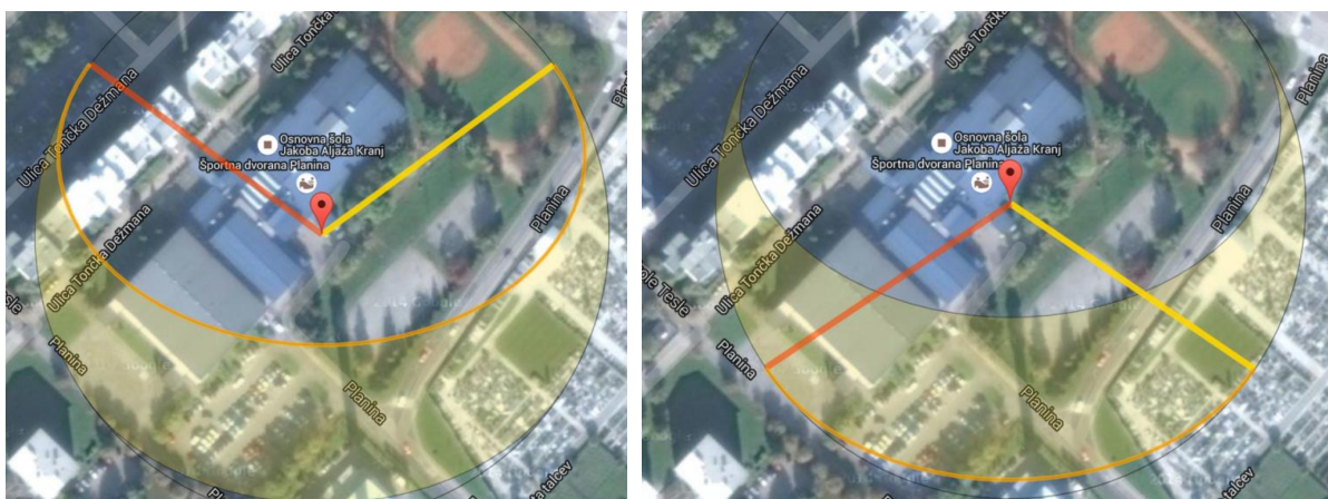
Slika 3: Prikaz poti sonca za dan 21.6. in 21.12. Rumena daljica prikazuje sončni vzhod, rdeča pa sončni zahod.
